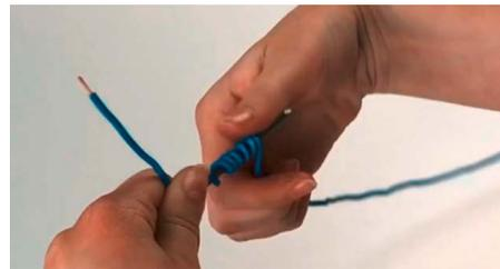
Du lässt an einem Ende des Nagels etwas Kupferdraht überstehen und wickelst ihn dann spiralförmig um den Nagel zum anderen Ende hin – ohne den Draht zu überlappen.
