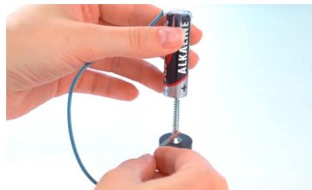
Nimm dir nun die Schraube an dem Magneten und hänge sie mit der Spitze an den anderen Pol der Batterie.
